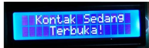
Gambar 10. Tampilan LCD setelah baca QR Code
