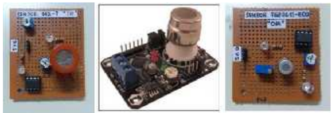
Gambar 7. Modul sensor untuk CO(MQ-7), CO 2 (MG-811), dan CH 4 (TGS2611-E00)
